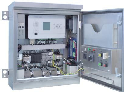
架空“三遥”终端即馈线终端，是安装在配电网架空线路杆塔等处的配电终端，与开关配合实时配电系统的运行监测，完成数据采集、线路保护、开关控制和与主站通信等功能，为配电网的实时监控和调度提供技术支撑。同时，既可以与主站配合实现集中式FA功能，也可以与上下级的终端配合实现分布式FA功能。
